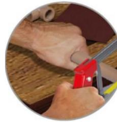
Cortar o tubo no esquadro e lixar as superfícies a serem soldadas (ponta do tubo e bolsa do Registro) para aumentar a aderência. Após, utilizando solução limpadora, limpe as superfícies lixadas para eliminar impurezas e oleosidade.
